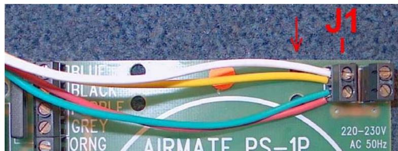
El indicador rojo (flecha) especifica el punto (2 agujeros) donde los cables deben ser montados a la placa del circuito impreso con una abrazadera.
